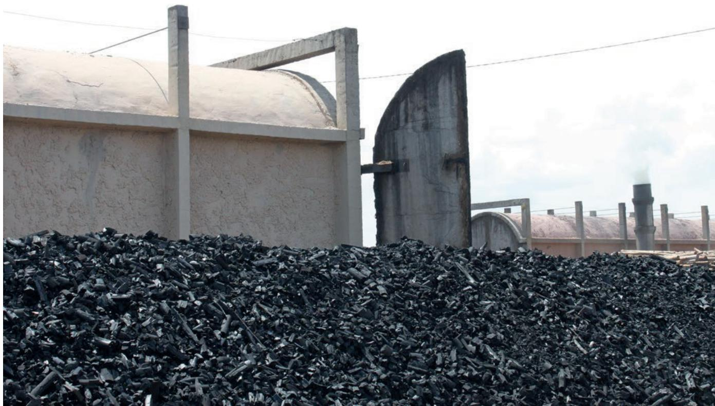
O carvão siderúrgico é produzido dentro dos padrões operacionais em fornos de alvenaria com o controle da temperatura por instrumentos de leitura ótica e por um sistema de monitoramento do processo que define os parâmetros de produção e ciclo ideal. O processo de carbonização, desde a ignição até o resfriamento completo, leva de dez a quinze dias, e varia com o tipo de forno utilizado.
