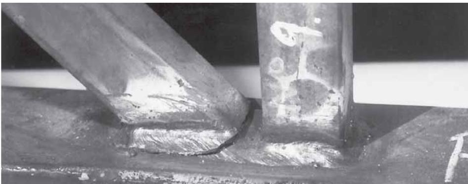
➤ Abb. 2.13: Verformungsverhalten von K- und N-förmigen Knoten aus RHP mit unmittelbar verschweißten Hohlprofilen
