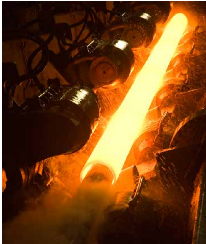
› Laminação Automática / Plug Mill Rolling (LA)
