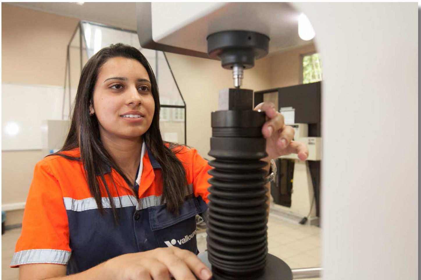
› Laboratório Metalúrgico – Ensaio de Dureza / Metallurgical Laboratory – Hardness Test
