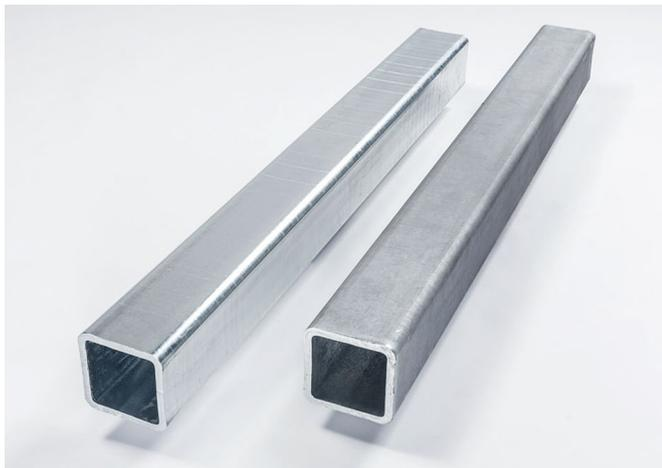
**Bild 2** Vergleich optische Schichtausbildung verzinktes Hohlprofil  $70 \times 70 \times 7,1$  der Stahlsorte S460NH: „Zn5Al“ (links) und „Zn ISO 1461“ (rechts)
